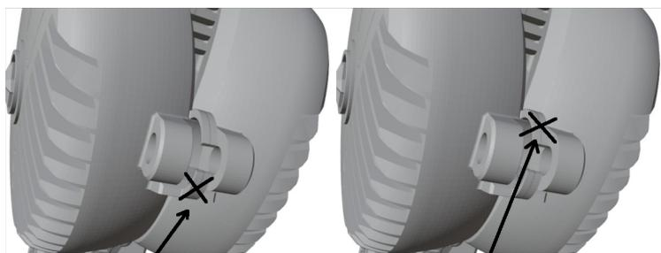
для сборки варианта с выпущенными посадочными опорами, нужно удалить нижний фиксирующий язычок в месте крепления задней посадочной опоры.
